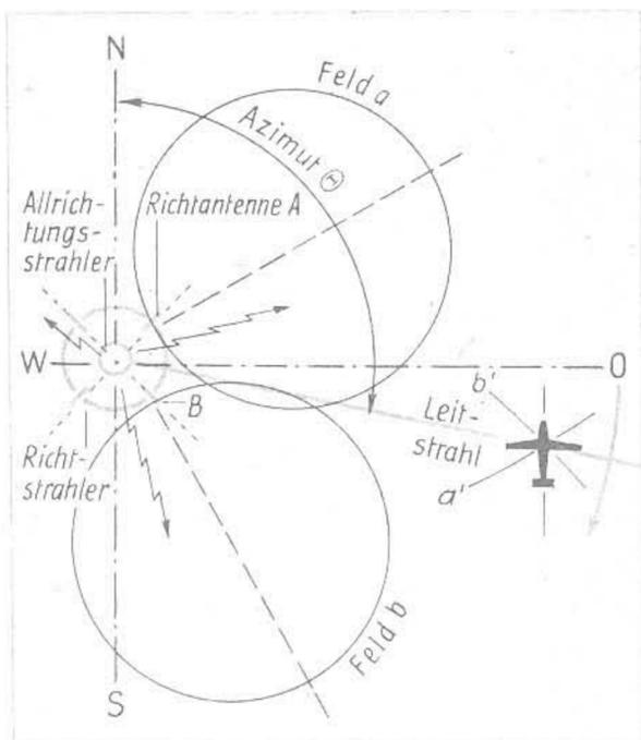
Abb. 6. Die von der Civil Aeronautic Administration entwickelte „CAA“-Azimutmessung. Geräte am Boden: Sender mit 4 Richtantennen und umlaufendem Leitstrahl; Allrichtungsstrahler. Geräte im Fahrzeug: Empfänger mit Phasenvergleich
