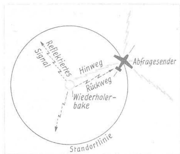
Abb. 7. Die Echo-Entfernungsmessung. Geräte am Boden: Wiederholersender. Geräte im Flugzeug: Abfragesender; Empfänger mit Zusatz für Messung der Impulslaufzeit oder Phasendifferenz
