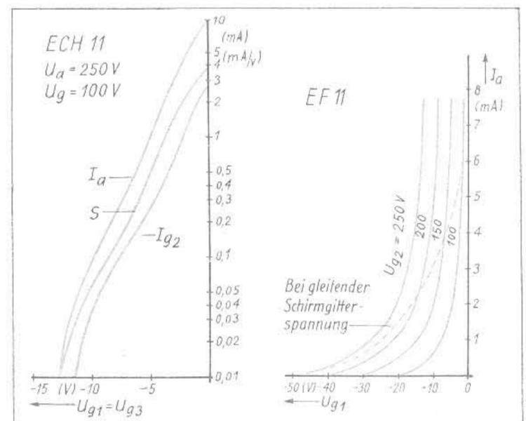
Abb. 14 (links). Anoden- und Schirmgitterstrom und Steilheit einer Regelhexode. — Abb. 15 (rechts). Gleitende Schirmgitterspannung bei einer Regelpentode
