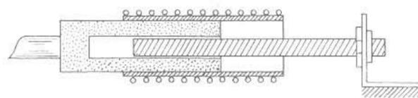
in dem Spulenkörper gewährleistet. Der bewegbare Kern hat eine zylindrische Längsbohrung, in die ein auf dem Chassis isoliert befestigter Metallstab genau passend eingreift und so ein Verkanten oder eine seitliche Bewegung des Kernes verhindert. Die Eintauchtiefe wird mit Hilfe des an der linken Seite des Kernes angesetzten Stiftes eingestellt. Kleidet man die Innenwand der
