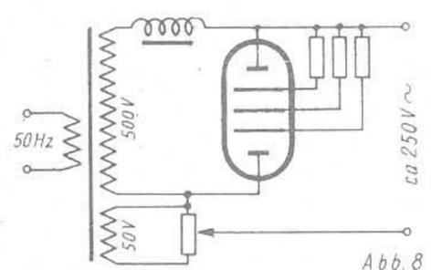
Abb. 8. Wechselspannungs-Stabilisierung
