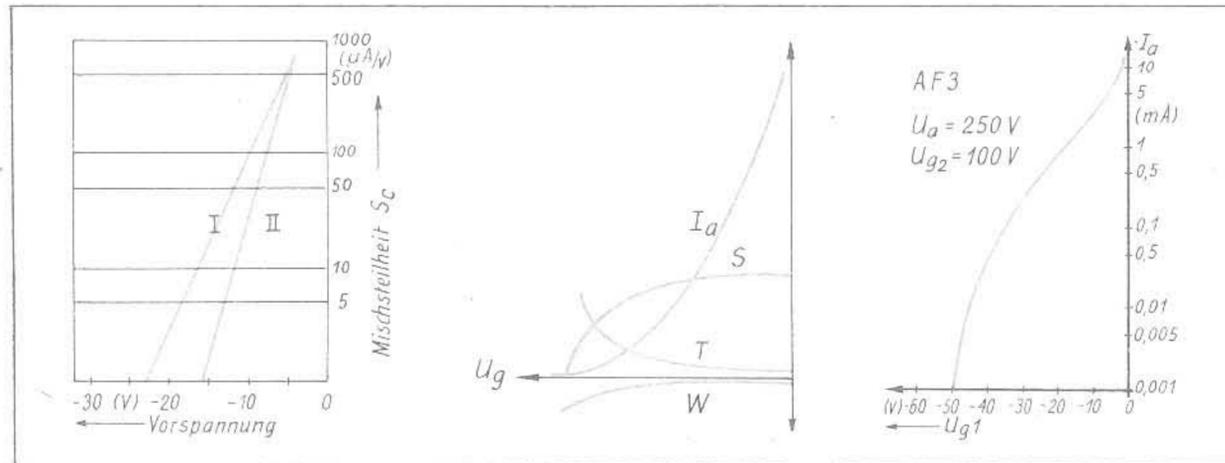
Abb. 10 (links). Mischsteilheit  $S_c$  in Abhängigkeit von der Gittervorspannung (Röhre ECH 11), Kurve I: mit fester, Kurve II: mit gleitender Schirmgitterspannung. Abb. 11 (Mitte). Der Anodenstrom, die Steilheit und ihr 1. und 2. Differentialquotient. Abb. 13 (rechts). Anodenstrom einer Regelpentode
