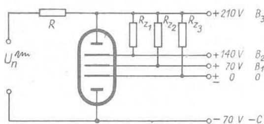
Abb. 6. Grundschialtung eines Stabilisators spannungen bis zu - 70 Volt an einem Ohmschen Spannungsteiler parallel zur Glimmstrecke O bis -C abnehmen kann. Die Kennlinien eines Stabilisators zeigt Abb. 5, die Grundschialtung Abb. 6. Die Widerstände R<sub>z</sub>, die mit etwa 1 Megohm dimensioniert werden, dienen zur Herbeiführung einer sicheren Zündung; fehlen
