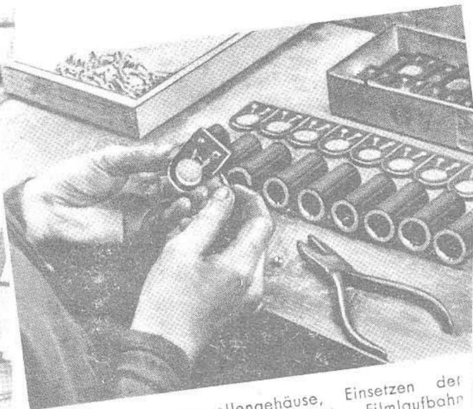
Montage der Fotozellegehäuse, Einsetzen der Steckerstifte. Rechts: Vormontage der Filmlaufbahn
