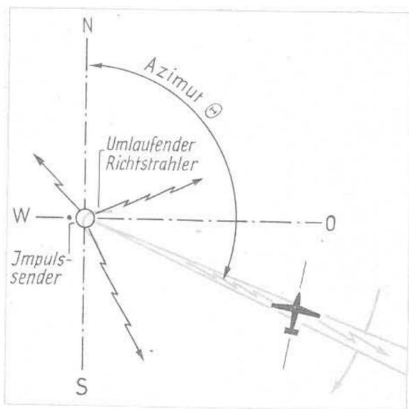
Abb. 4. Prinzip der „Navar“-Azimutmessung. Geräte am Boden: Richtstrahler mit Umlaufantenne; Impulssender, allseitig bei Norddurchgang des Umlaufstrahles sendend. Geräte im Fahrzeug: Empfänger mit Zeitmeßeinrichtung
