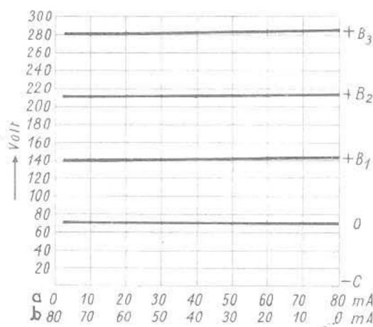
Abb. 5. Kennlinien eines Stabilisators; Querstrom a und Betriebsstrom b
