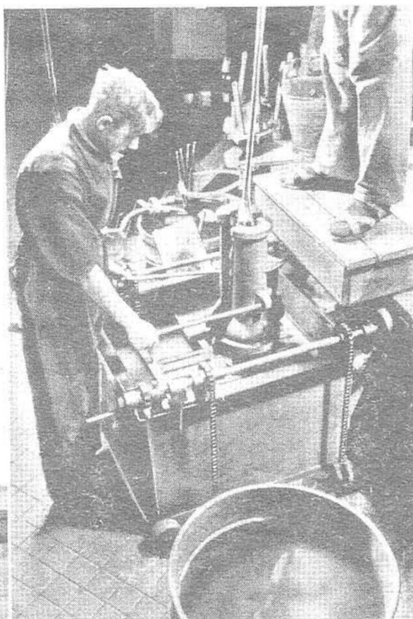
Vorsichtig öffnet der Gehilfe die zweiteilige Form. Nach Prüfung klopft der Glasbläser den fertigen Kolben ab, der vorher mit einer Feile eingekerbt wurde
