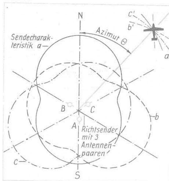
Abb. 5. Prinzip der erstmalig 1946 vorgeschlagenen „Navaglobe“-Azimutmessung. Geräte am Boden: Sender mit nacheinander gefasteten Richtantennenpaaren. Geräte im Fahrzeug: Empfänger mit Einrichtung für Feldstärkenvergleich
