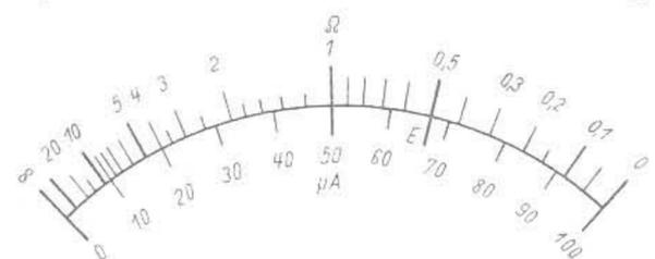
Abb. 4. Umgekehrte Skala für Widerstandsmessung
